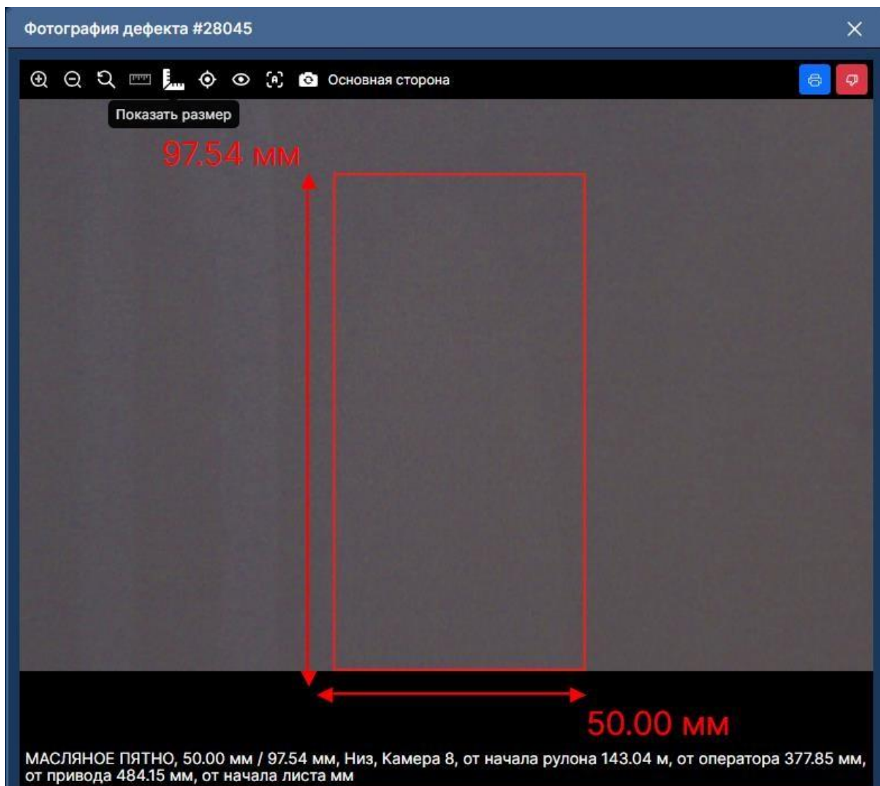
Рисунок 37. Автоматическое измерение размеров дефекта
